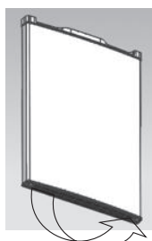
die Tür Lagerbuchse und den Begrenzungsblock ersetzen
